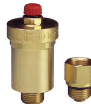
Zawór odpowietrzający do pionu z zaworem stopowym + o-ring Max. temperatura 110°C Max. ciśnienie 10 bar Glikol 50%
